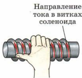
Рис. 97. Определение направления линий магнитного поля внутри соленоида
